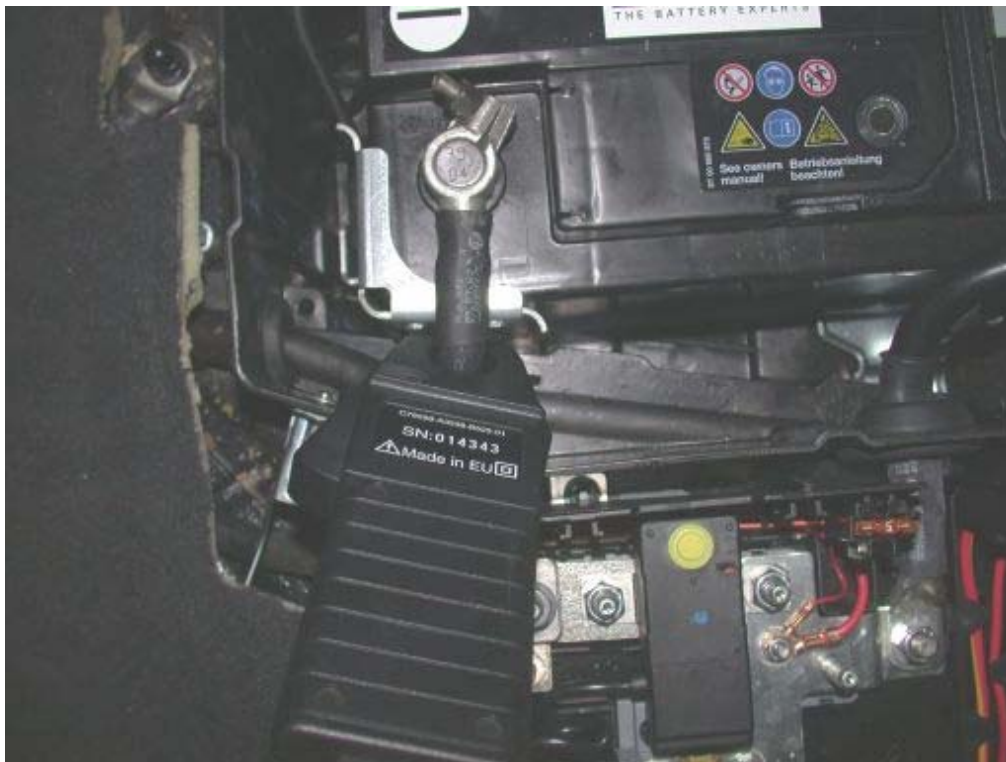
Abbildung 2: Anschluss der Stromzange für Langzeitruhestrommessung
