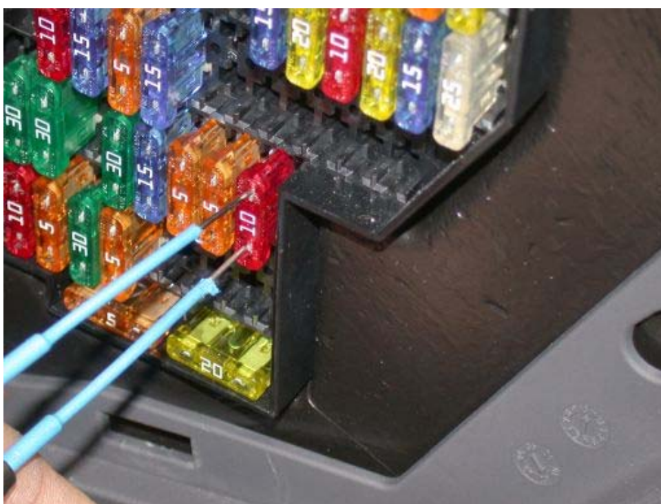
Abbildung 11: Strommessung über Sicherung
