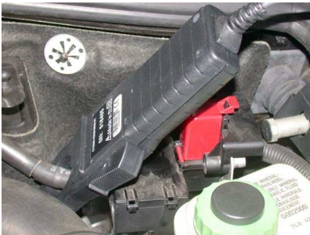
Abbildung 10: Anbringen der Stromzange an der Generatorleitung
