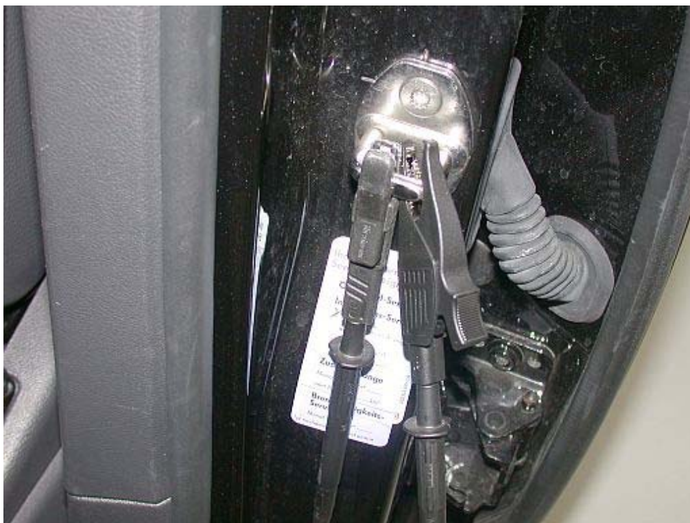
Abbildung 12: Kontaktierung der Messleitungen masseseitig zur CAN-Bus Messung
