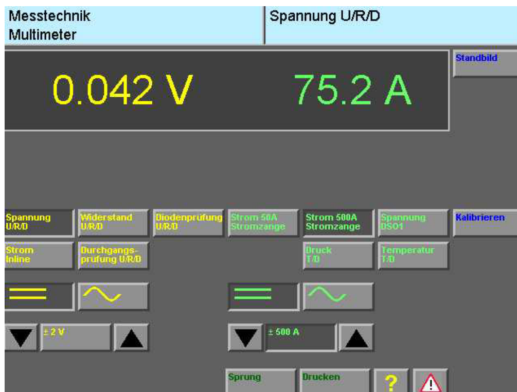
Abbildung 9: Beispiel für i.O. Spannungsabfallmessung
