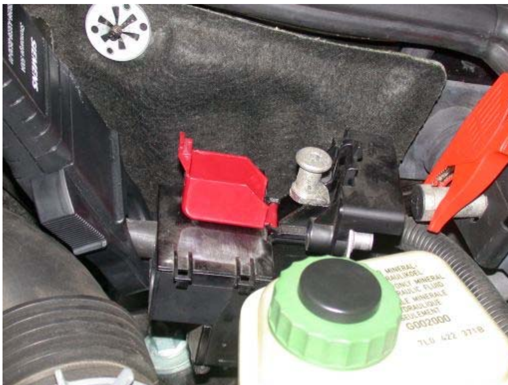
Abbildung 7: Anschluss von Stromzange und Messleitung zur Spannungsabfallmessung "Masseband"
