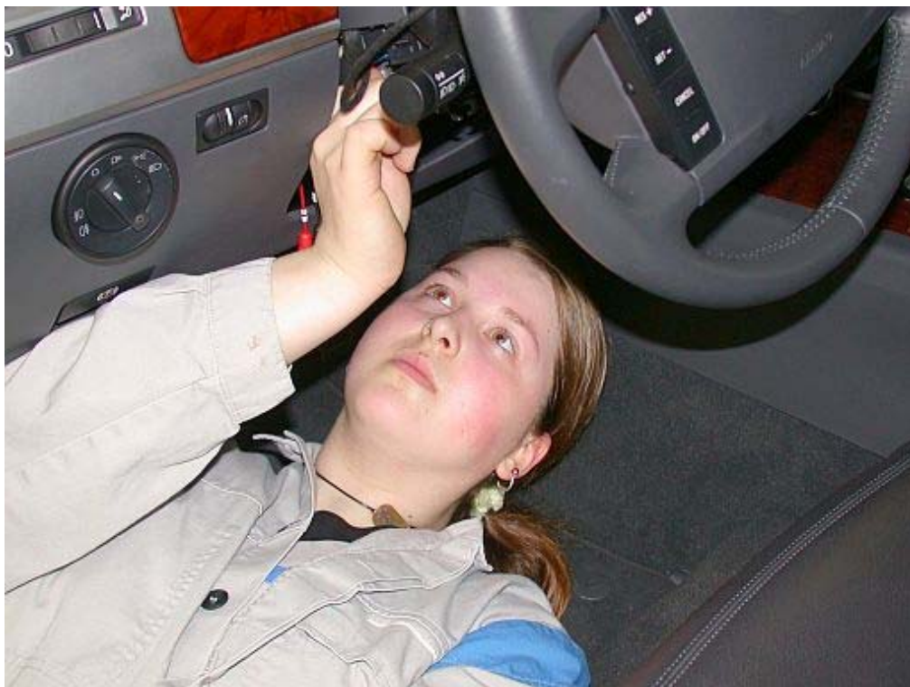
Abbildung 13: Arbeitsposition zum Kontaktieren der Messleitungen am CAN-Bus Komfort am Lenksäulenmodul
