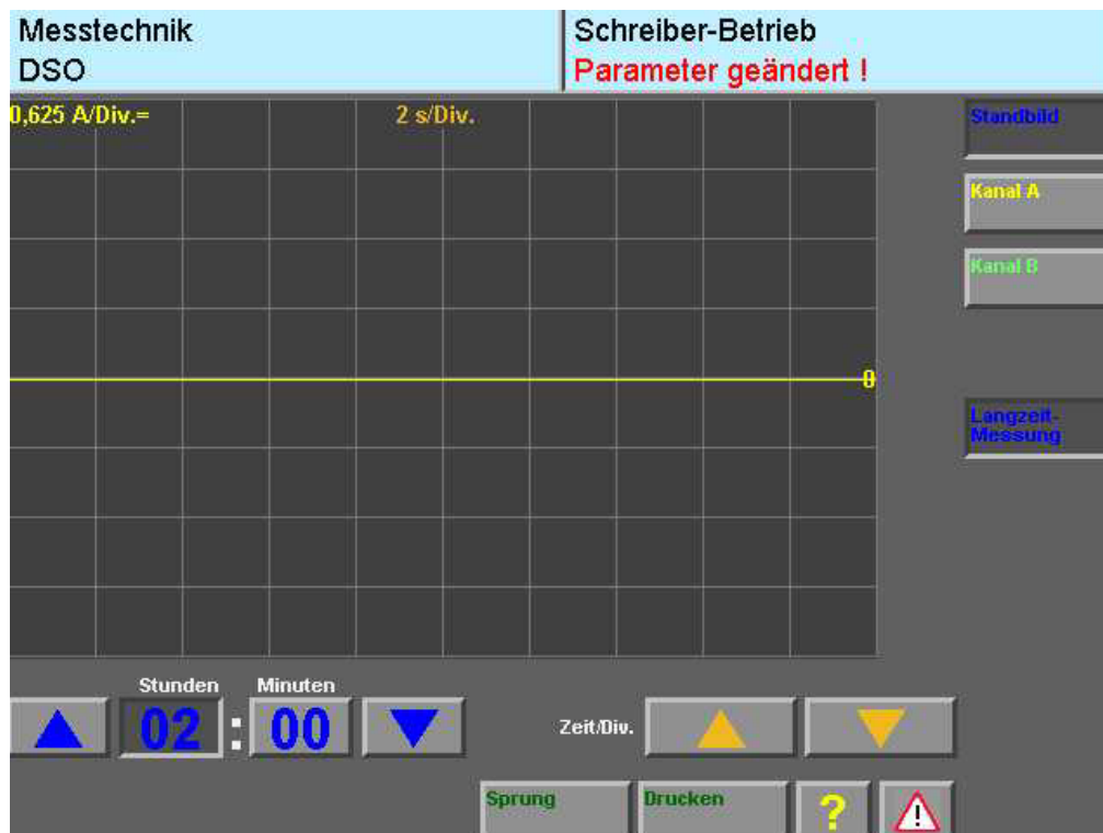
Abbildung 1: Einstellung DSO für Langzeitruestrommessung
