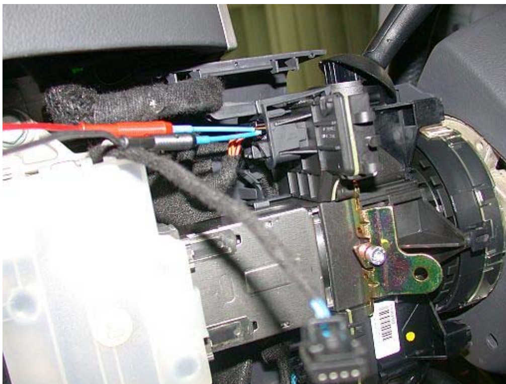
Abbildung 14: Kontaktierung der Messspitzen am CAN-Bus Komfort
