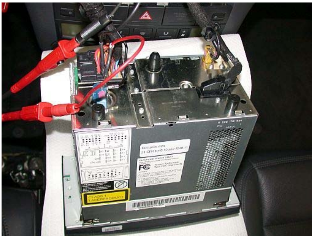
Abbildung 17: Kontaktierung der Messspitzen am CAN-Bus Infotainment
