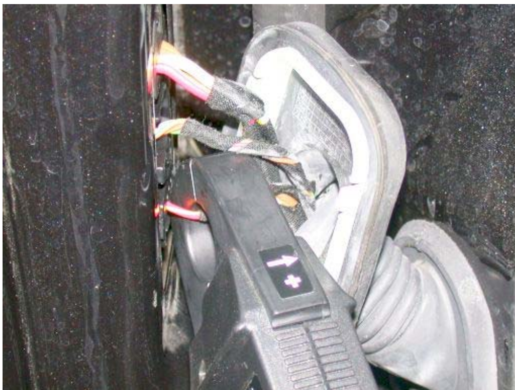
Abbildung 5: Strommessung Stromversorgung Tür
