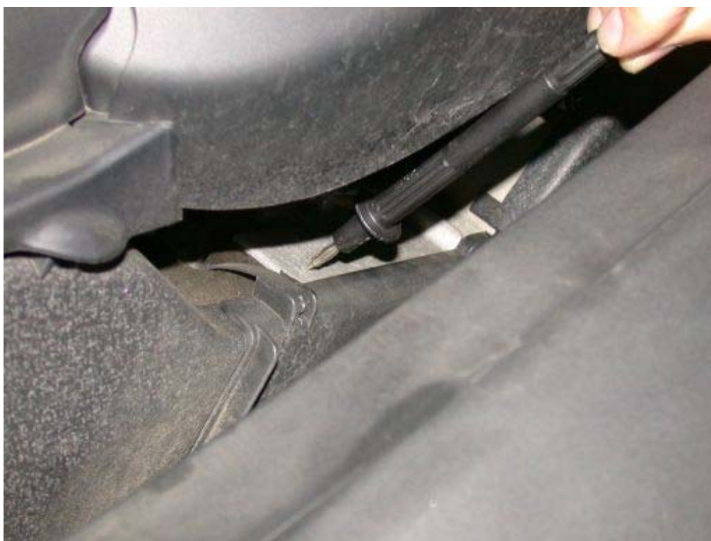
Abbildung 8: Anschluss der 2. Messleitung auf dem Motorblock für die Spannungsabfallmessung
