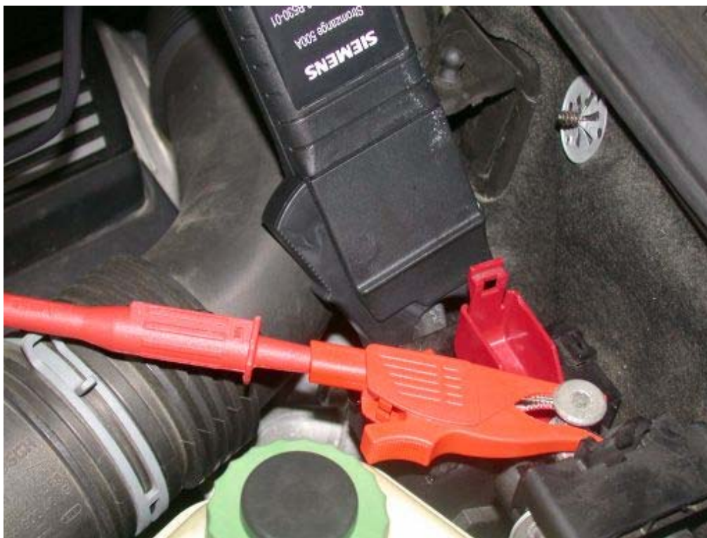
Abbildung 6: Anschluss von Stromzange und Messleitung zur Spannungsabfallmessung Generator +-Leitung
